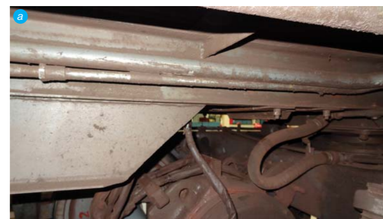
Рис. 2. Хребтовая балка с усилением: а) до усиления; б) после усиления
