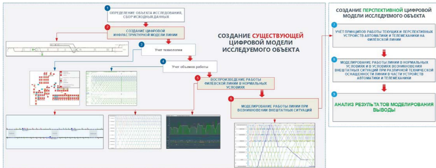
Рис. 2. Укрупнённая схема построения цифровой модели Филёвской линии Московского метрополитена
