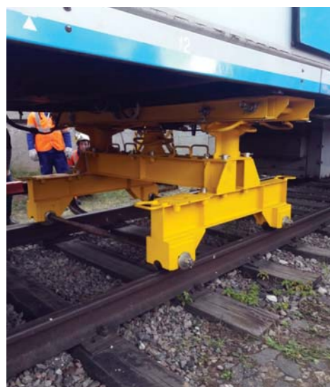
Рис. 8. Универсальная тележка в собранном виде под вагоном серии 81-740/741 «Русич».
