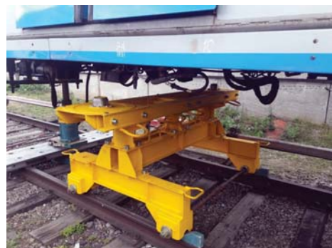
Рис. 7. Универсальная тележка установлена под вагоном серии 81-740/741 «Русич» с пневматическим центральным подвешиванием.
