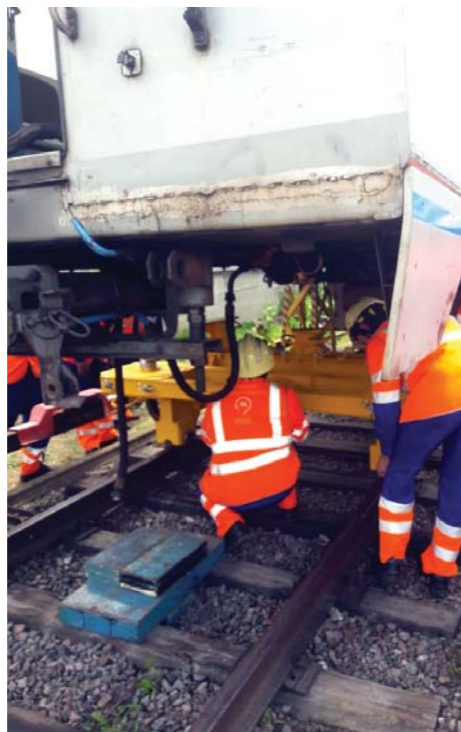
Рис. 9. Установка и позиционирование аварийной тележки на штатное место вагона.
